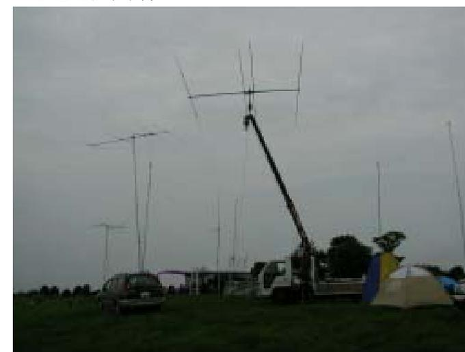
アンテナ群は3.5Mhzと7Mhzがフルサイズダイポール(今年は高さを稼いだせいか良く飛んでくれました)、14Mhzがそういう訳でダイポール、21MhzはJA7EU作の4エレモノバンド八木、28MhzはVダイポール、50Mhzは5エレモノバンド八木、144Mhzは10エレ八木、430Mhzは15エレ八木、1200Mhzは12エレループ八木とGP、他に144/430のGPというラインナップです。
